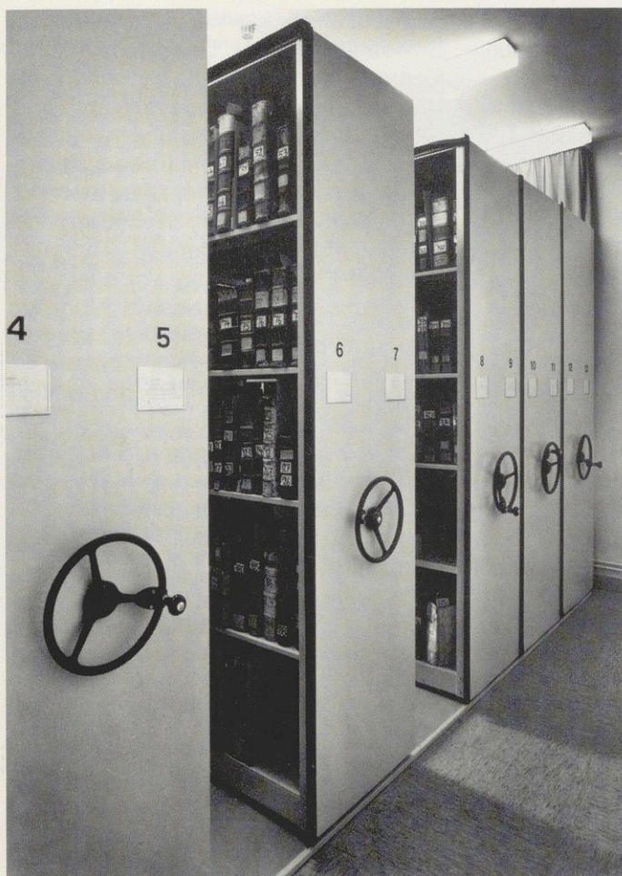
Neuartige Schiebe-Doppelregale des Bistumsmagazins für stehende Handschriften, Inkunabeln und gebundene Aktenfascikel. Zusammengeschoben bilden die Regalwände einen geschlossenen Magazinschrank.
